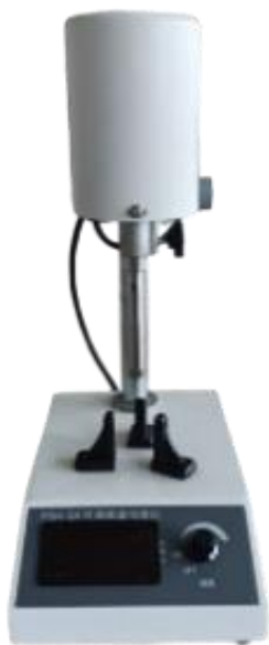
Gambar 1. Rotor Stator Homogenizer ( High speed homogenizer FSH-2A ) yang digunakan untuk mensintesis nanopartikel kurkumin pada penelitian ini. Diameter rotor 10 mm, diameter stator 12 mm, dan jarak antara rotor dan stator 0,05 mm.
