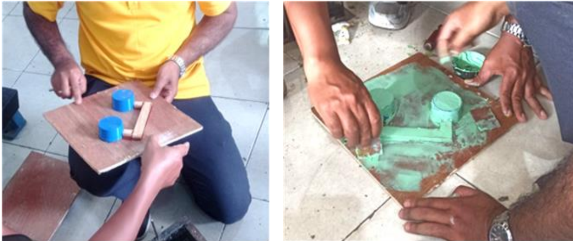
Gambar 10. Penempelan saluran pengalir dan pendempulan pada pola
