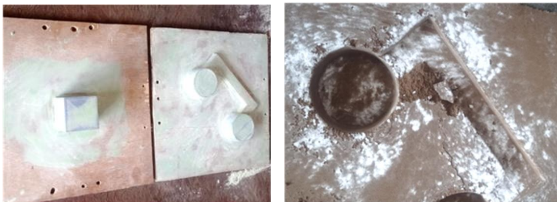
Gambar 11. Pelat yang telah halus dan cetakan pasir runtuh
