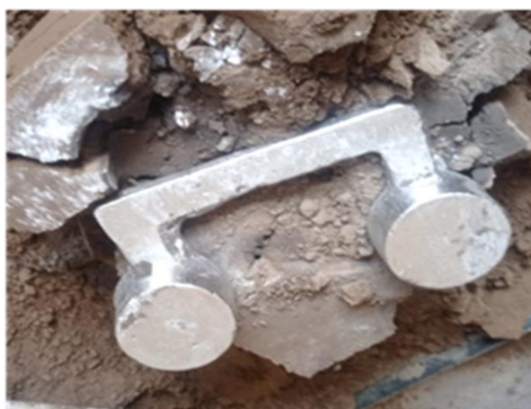
Gambar 12. Hasil pengecoran sesuai pola cetakan
