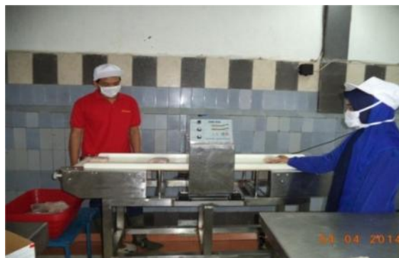
Gambar 12. Pendeteksian Metal Pada Produk
