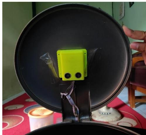
Gambar 5. Penempatan Sensor Pada Penutup Tempat Sampah
