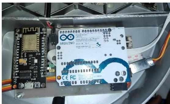
Gambar 6. Arduino Uno dan Nodemcu
